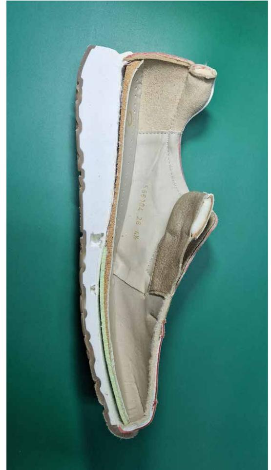
Einfaches Beispiel. Links der minderwertige Wegwerf-Sneaker. Sein Sohlenaufbau mit einer Hohlkammer-Laufsohle lässt eine Reparatur nicht zu. Ist die Sohle abgelaufen, so ist der Schuh irreparabel und muss auf den Müll. Rechts dagegen die nachhaltigere Konstruktion: eine Laufsohle und ein Sohlenkörper aus massivem Schaummaterial. Die Laufsohle kann jederzeit erneuert werden, bei guter Pflege hält so ein Sneaker jahrelang.
